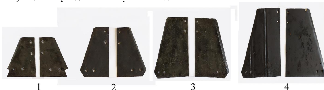
1, 2, 3, 4-мос равишда узунлиги 25, 35, 45, 55 см бўлган тупроқ йўналтиргичлар 1-расм. Ҳар хил узунликда тайёрланган тупроқ йўналтиргичлар
