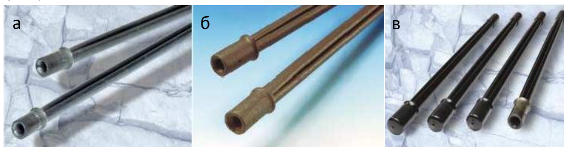
Рис. 10 - Типы анкеров «Swellex» а) обычные анкера; б) анкера с антикоррозионной защитой на основе битума; в) анкера с поливиниловым покрытием
