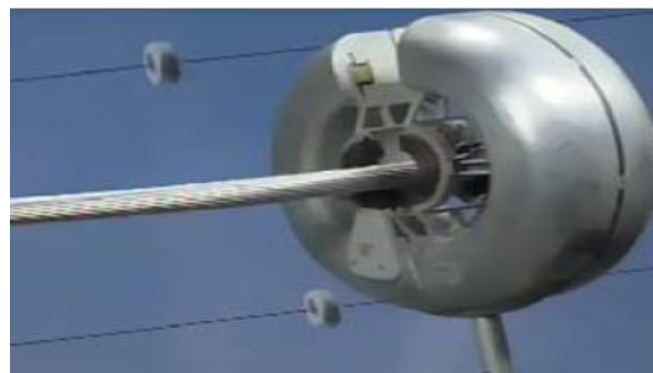
5-6-rasm. O'lchagichning elektr uzatish o'tkazgichiga o'rnatilishi
