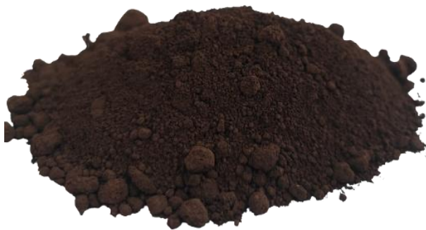
1-rasm. "O'zmetkombinat" AJ YPE pechidan hosil bo'lgan chang namunasi.
