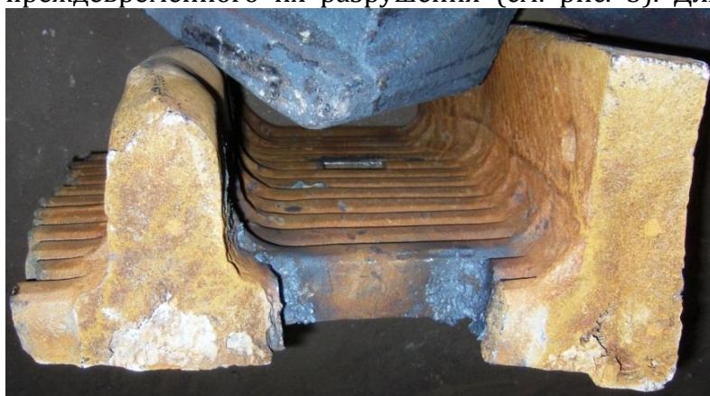
Рис. 3. Поверхность разрушения футеровки.
