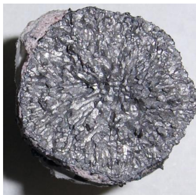
Рис. 2. Вид излома литого образца-свидетеля (а) и образца -свидетеля после термической обработки (б).
