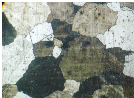
Рис. 7. Микрофотографии не модифицированного (а) и модифицированного (б) образца-свидетеля, прошедших термообработку, увеличение x100.
