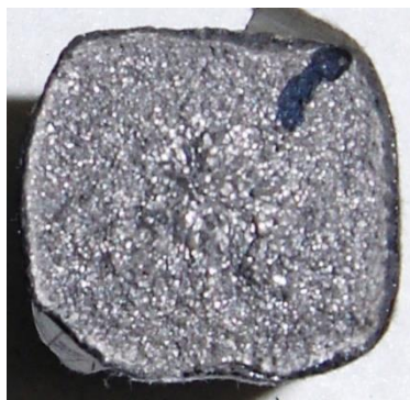
Рис. 2. Вид излома литого образца-свидетеля (а) и образца -свидетеля после термической обработки (б).
