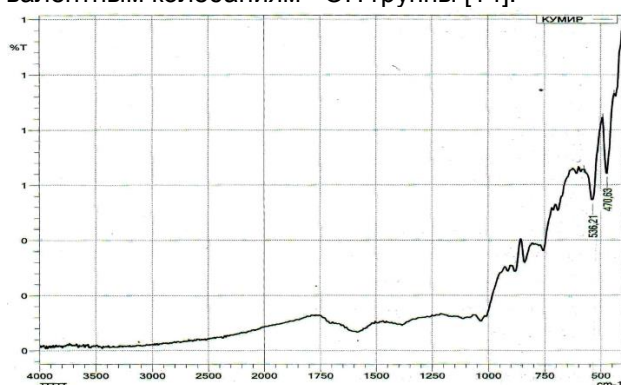
Рис. 2. ИК-спектры исходного угля до пиролизной обработки.
