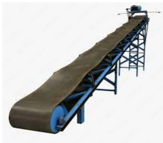
1-rasm. Tasmali konveyerning umumiy ko'rinishi.
