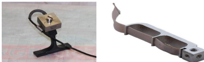
1-расм. Маҳаллий титрашни ўлчаш мосламалари келтирилган.
