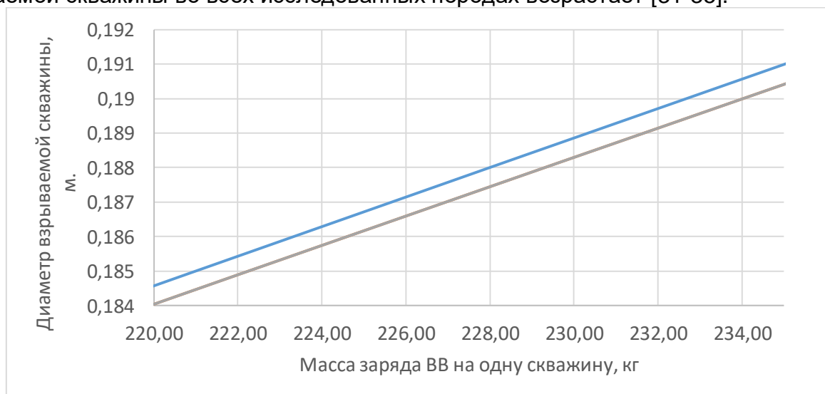
Рис. 2. Зависимость изменения массы заряда ВВ на одну скважину от диаметра взрывающей скважины
