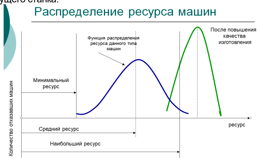
Рис.1. Эффективность применения вибромониторинга для металлорежущих станков.
