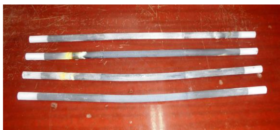
Рис.3. Карбидокремниевые нагревательные элементы, пришедшие в непригодное состояние.
