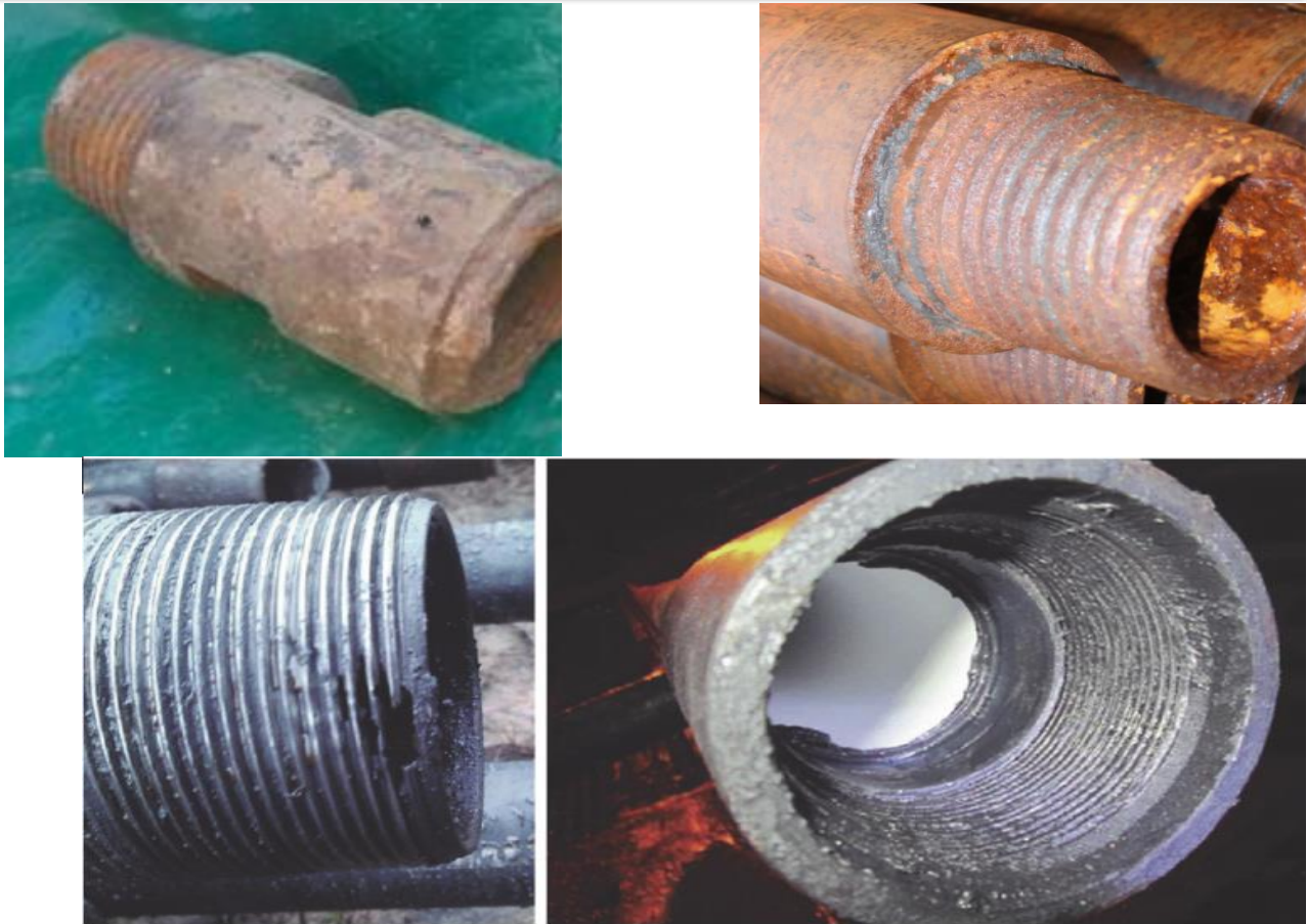
3-rasm. Burg'ilash quvurining qulfli ulanishida rezba qismining uzilish va rezbaning yemirilganlik holati.
