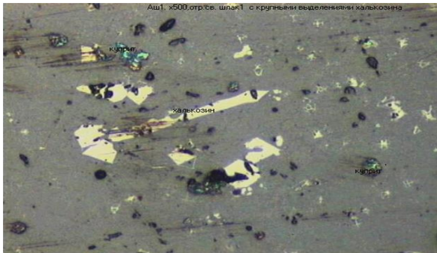
4-rasm. SHlakda yirik xalkozinning hosil bo'lishi 1-kuprit; 2-xalkozin.
